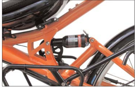
Federelement DT-Swiss XM180. Die Einstellung der Dämpfung erfolgt über das rote Rad am hinteren Ende. Das Federelement muss so eingebaut sein, dass die Kipphebel zur Blockierung am hinteren Ende nach oben zeigt, damit er nicht am Hinterbau anschlägt.
