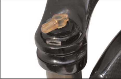
Drehknopf für die Dämpfungseinstellung der Federgabel MEKS Carbon AC
