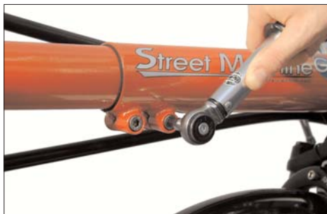
Lösen der Klemmschrauben zum Verstellen des Tretlagerauslegers.
