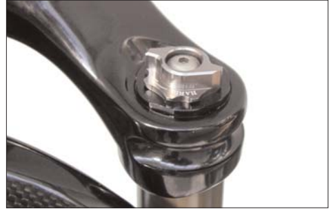
Drehknopf für die Federvorspannung der Federgabel MEKS Carbon AC
