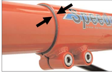
Zwischen Hauptrahmen und Tretlagerausleger muss die Distanzbuchse von vorne sichtbar sein. Fehlt diese, kann der Rahmen beschädigt werden.
