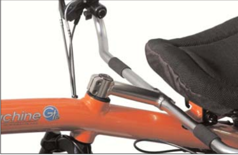
Der Lenker wird über den Vorbau mit der Gabel verbunden. Die Klemmverbindung zur Gabel erfolgt über die beiden seitlichen Schrauben.
