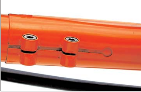
Beim Blick von unten in den Klemmschlitz darf das Ende des Tretlagerauslegers nicht sichtbar sein.
